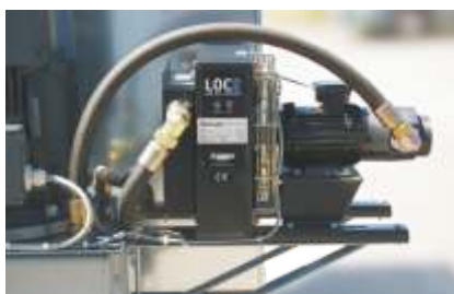
Optional: Ölkühlung für Hydraulikaggregat
