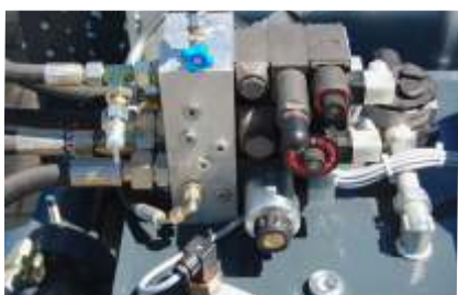
Sensor für Öltemperatur Optional: Ölmangelschalter
