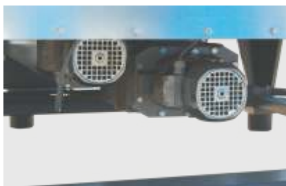
Starke Getriebemotoren für Schnecken- vorverdichtung und Rührwerk
