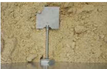
Optional: Füllstandsmelder für automatischen Start der Maschine
