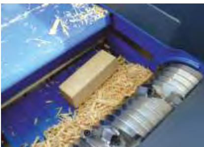
Rotor mit einer Messerreihe für geringe Leistungsaufnahme
