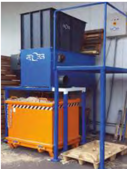
GAZ 82 S über Container gestellt
