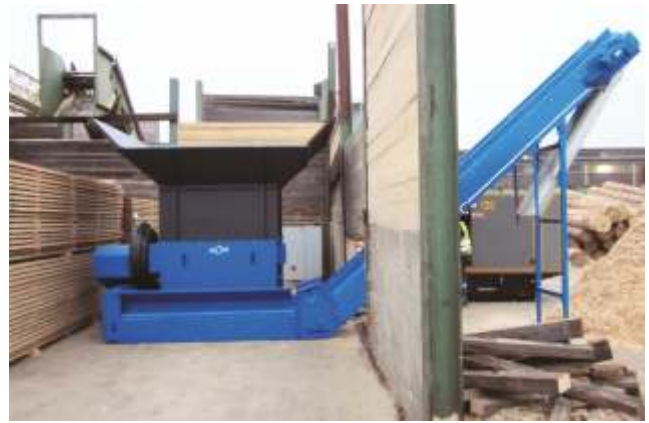
GAZ Holzerkleinerer mit Förderband und Magnetrolle
