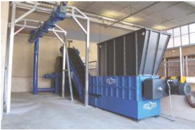
Vorzerkleinerer, Materialaustrag mit Förderband und Materialaufgabe in einem GZ-Vierwellenzerkleinerer
