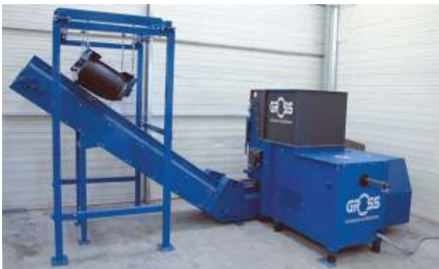
GAZ-K Einwellenzerkleinerer mit L-Band und Überbandmagnet zur Dokumentenvernichtung und zur Festplattenzerkleinerung
