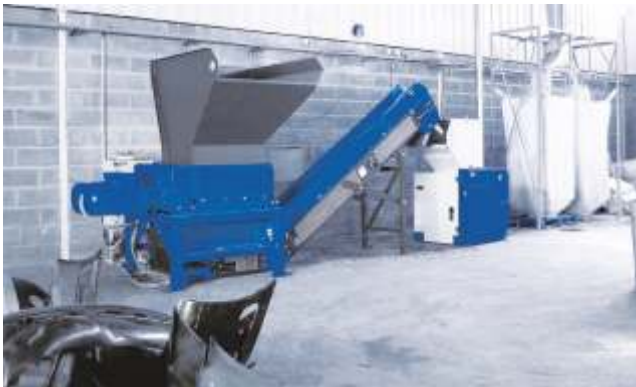
GZ Vierwellenzerkleinerer, Materialaustrag mit Förderband in einer dahinter geschalteten schallgeschützten Schneidmühle
