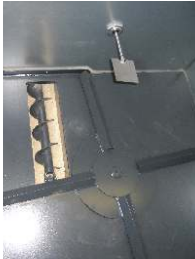
Rührwerk, Förderschneckenverdrichter und Füllstandsmelder im Inneren Agitator, conveyor worm supercharger and level sensor inside
