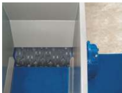
Trichter und Rotor mit 362 mm Durchmesser
