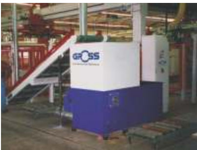
GAZ 82 mit Sondertrichter (schallisoliert, doppelwandig)
