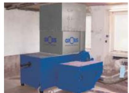
GAZ 102 Unterflur aufgestellt, mit Trichterweiterung
