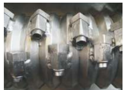
Profilorotor mit geschweißten Messerträgern
