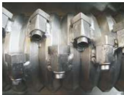
Profilrotor mit geschweißten Messerträgern (GAZ 62 S)
